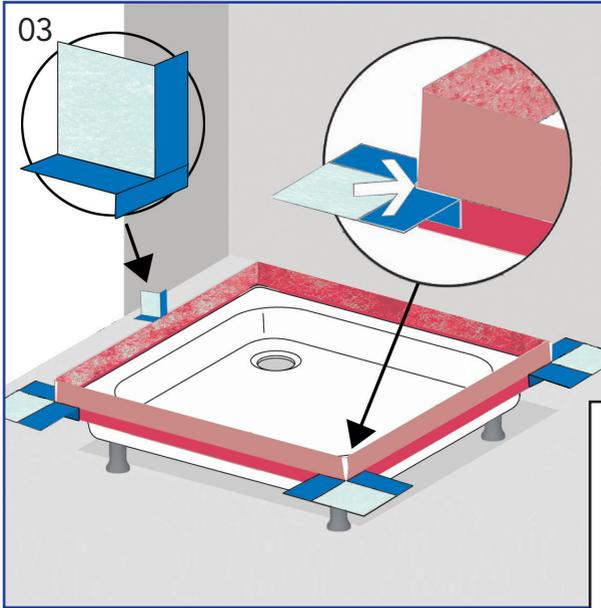
Bei den Wannen-Eckdichtungen 3d die Schutzfolie des grauen Butylklebers abziehen, beim Zargen-Wannendichtband unterhalb der Schutzfolie aufkleben.
