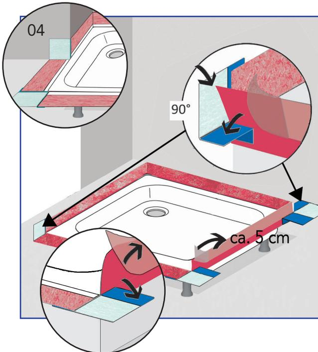
Die Schutzfolie des Zargen-Wannendichtbandes ca. 5 cm abziehen. Das Zargen-Wannendichtband auf die vliesfreien Seitenteile der Wannen-Eckdichtungen 3d kleben und abdichtend andrücken.
