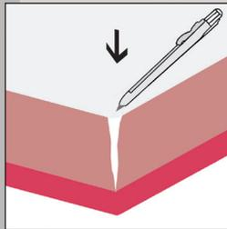
In den Ecken bei den Übergängen Wand/Boden und Boden/Boden den oberen Teil des Zargen-Wannendichtbandes bis zum Butyl einschneiden.
