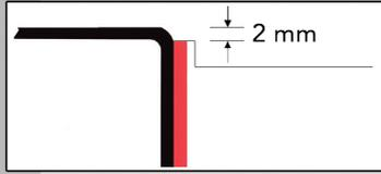
Das Band an der vorderen Ecke beginnend umlaufend auf den unteren Wannenrand mit einem Abstand von 2 mm zur Wannenoberfläche kleben. Bei den Bandenden das kleine Butylabschlusstück abdichtend aufkleben.
